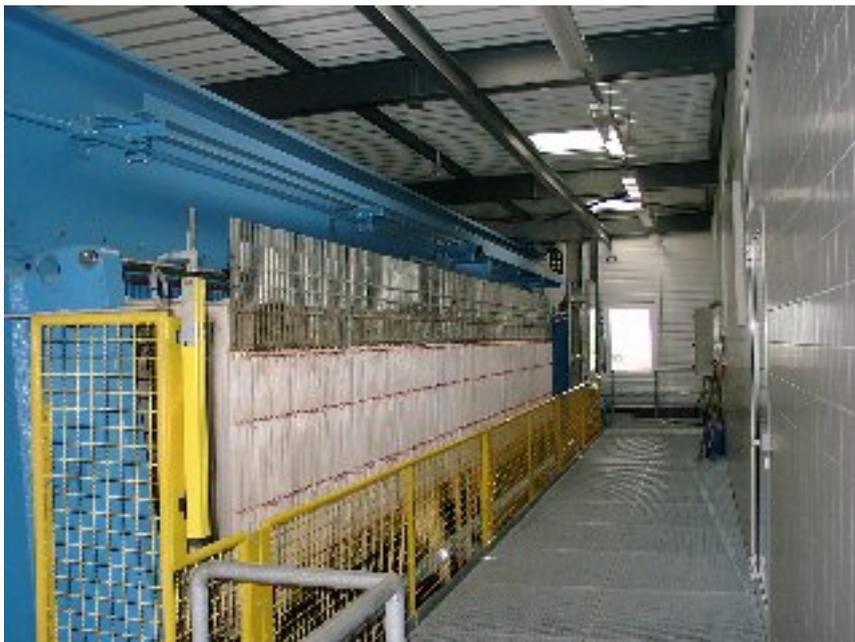
Der Schlamm aus dem Nacheindicker hat einen Wasseranteil von rund 96% und ist damit flüssig. Um Kosten zu sparen und die Handhabung des Schlammes zu erleichtern, wird er auf der Kammerfilterpresse entwässert. Die jeweils mit einem Filtertuch umspannten
